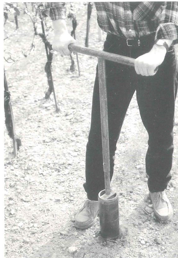
Trivella realizzata dall'Istituto Coltivazioni Arboree dell'Università di Milano per le indagini pedologiche. È possibile determinare le percentuali di porosità ed umidità dei campioni di terreno di volume noto così prelevati.
