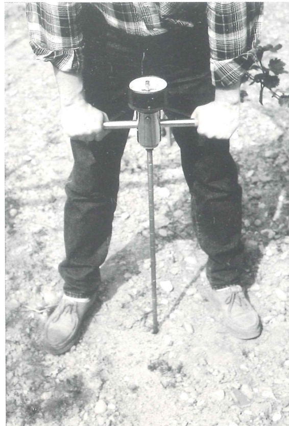
Penetrometro manuale Eijkelkamp '74. Permette la misura della resistenza che il terreno offre alla penetrazione ed allo schiacciamento, conseguente alle forze di coesione che tendono a tenere unite le particelle terrose.
